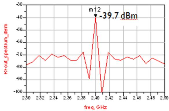
Figure 70 LNA output spectrum
